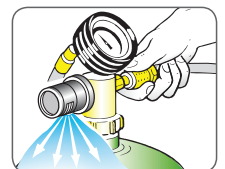
Давление воздуха для правильной разгерметизации находится в пределах от 6,5 до 7 бар
